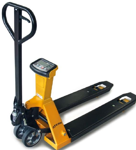
Der Betrieb erfolgt über 4 handelsübliche AA-Batterien und kann mit einer Ladung bis zu 80 Stunden genutzt werden. Die Anzeige verfügt über die Schutzart IP65 und die Lastgabeln über Schutzart IP67. Damit ist eine kurzzeitige Verwendung im Nassbereich möglich.
