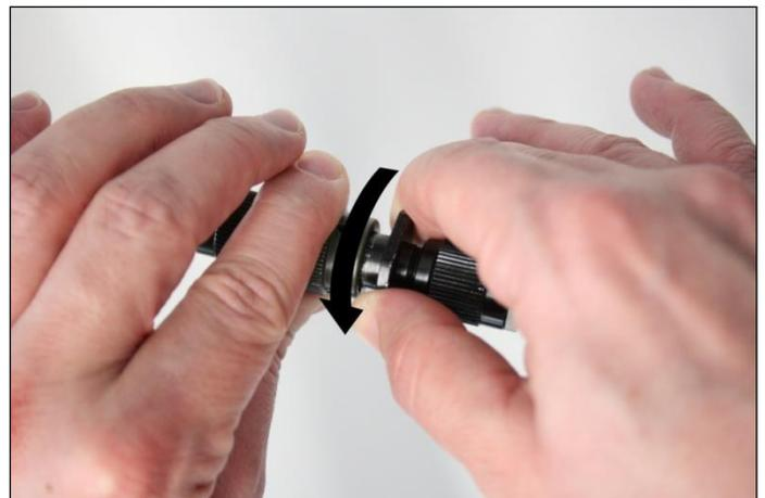
Nehmen Sie den Kabelanschluss des Batterie-Ladegeräts - oder des Indikators - in die rechte Hand - genau am quadratischen Querschnitt. Schieben Sie mit der linken Hand den Batterie-Kabelstecker darauf (Bild links). Verdrehen Sie nun wie durch den Pfeil angezeigt (Bild rechts) die beiden Teile gegeneinander bis der Anschluss richtig sitzt.
