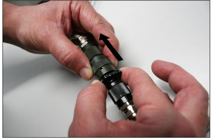
Zum Trennen Nehmen Sie die Kabelkupplung in die Hände und verdrehen sie wie durch den Pfeil (Bild links) angezeigt. Fassen Sie den Kabelanschluss (quadratischer Querschnitt) und ziehen den Batterie-Kabelstecker (Bild rechts) ab.
