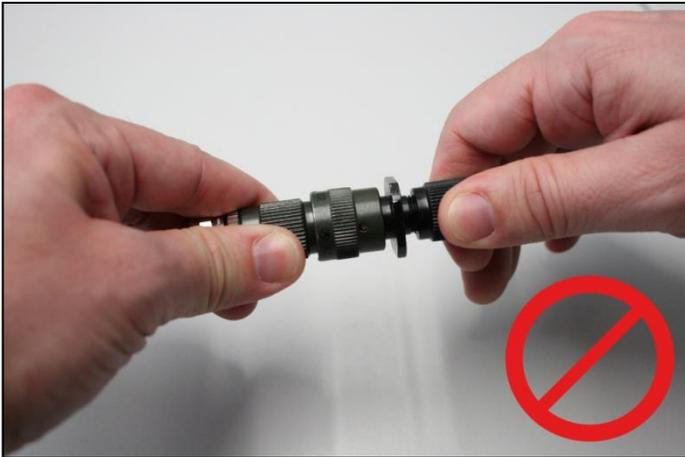
Vermeiden Sie unbedingt beim Verbinden / Trennen der Kabelkupplung die äusseren Teile von Stecker / Buchse anzufassen, da hier Gefahr besteht, das die internen Drähte brechen/abreissen.
